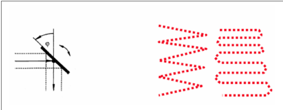
4. ábra: Oszcilláló tükrös szkennerek működési elve, a mért pontok elhelyezési sémája [2]
