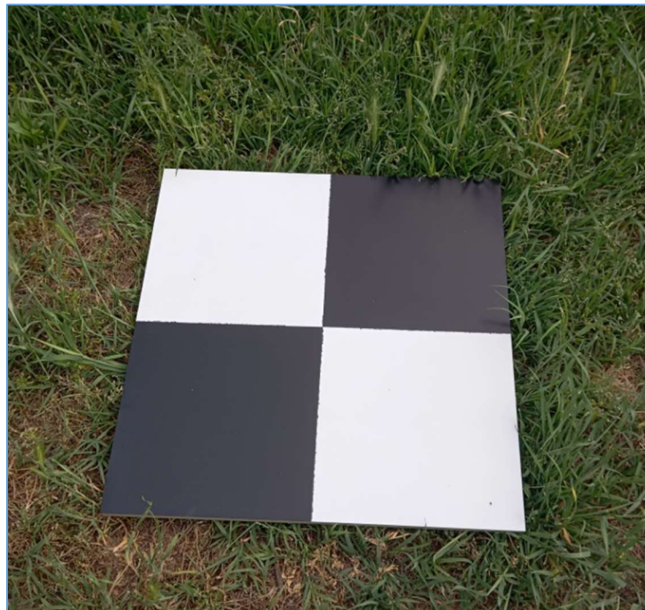
17. ábra Illesztőpont(GCP) [saját forrás]
