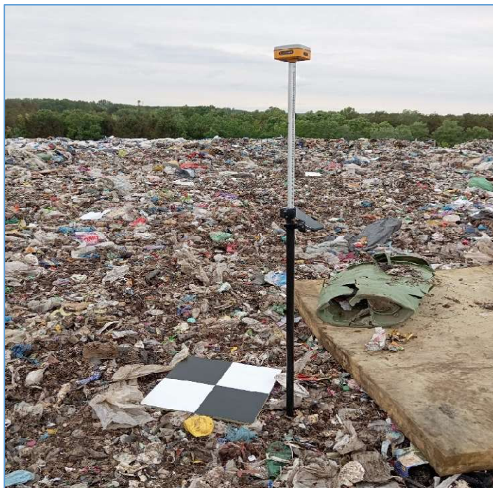
19. ábra Illesztőpont mérés GNSS RTK vevővel [saját forrás]
