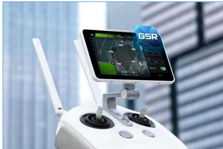
7. ábra GSR beépített repülési terv készítő szoftver [8]
