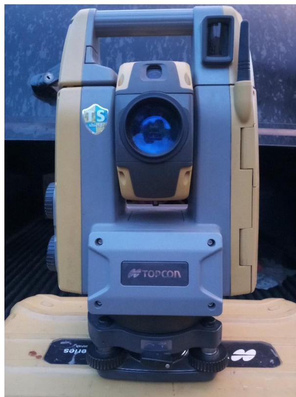
4.2.1 ábra: a Topcon GT-1003 robot mérőállomás látható Forrás: [4]
