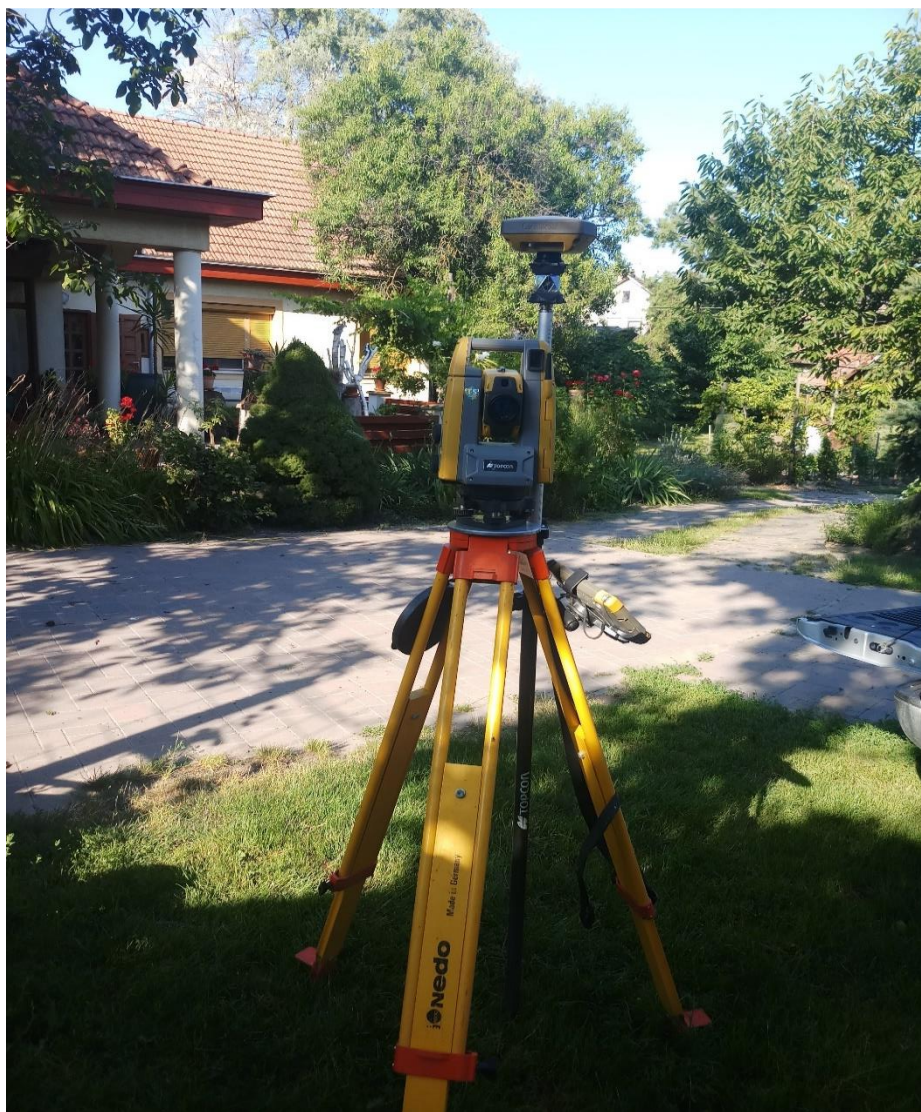
5.1.3 ábra: A képen a cégnél használatos robot mérőállomás a hozzátartozó GNSS vevővel és kezelővel látható Forrás: [4]
