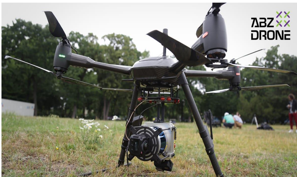
4.3.1 ábra: egy LIDAR-al szerelt drón látható - Forrás: [7]
