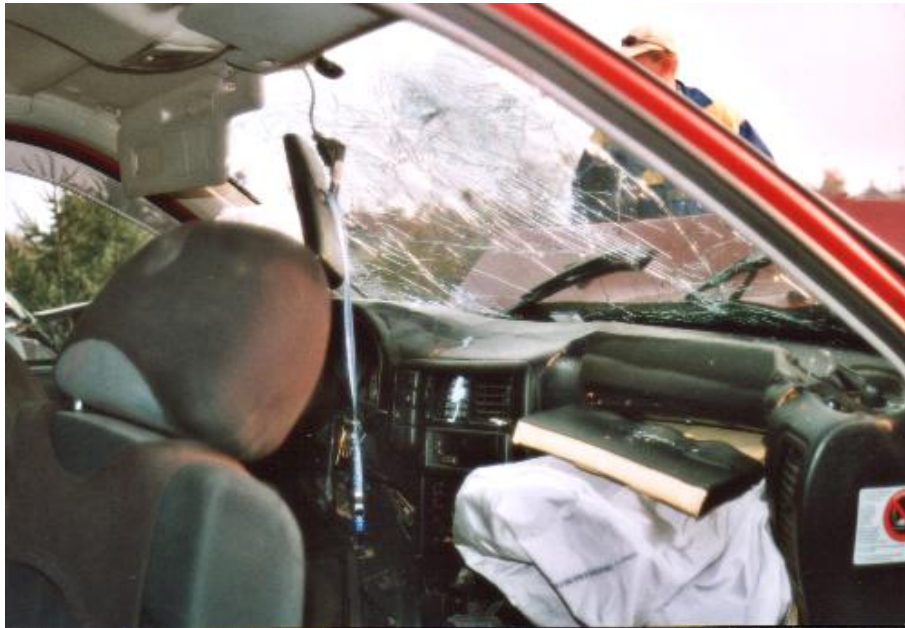
5.1. ábra: Fényképfelvétel személygépkocsi „kifejelt” szélvédőjéről (Saját készítés)
