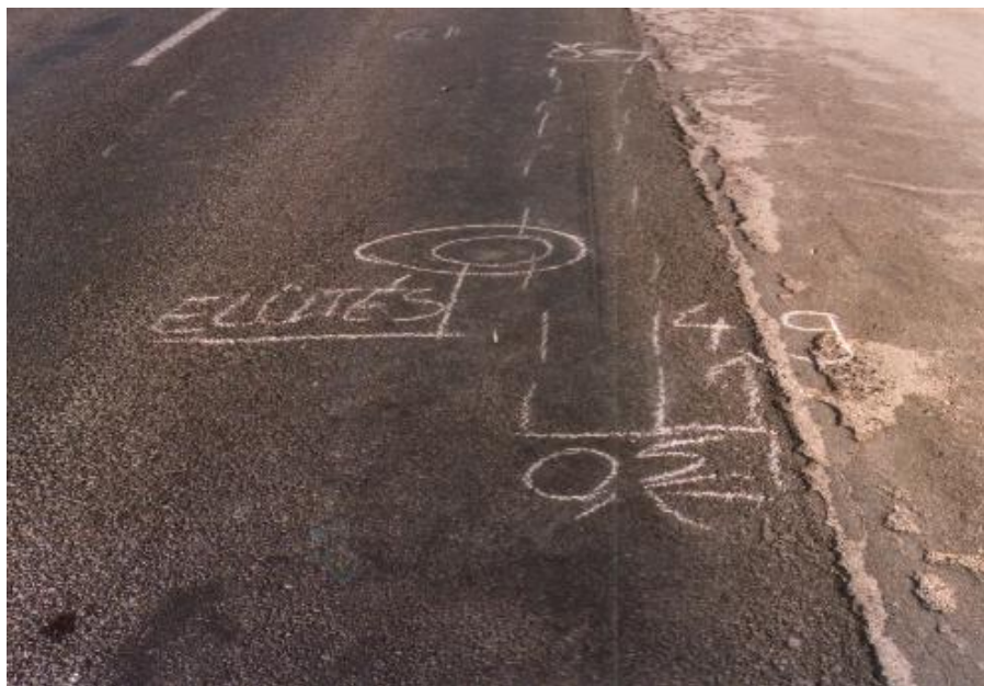
5.4. ábra: Gyalogos lábbelijének az elütés következtében keletkezett nyoma (Saját készítés)
