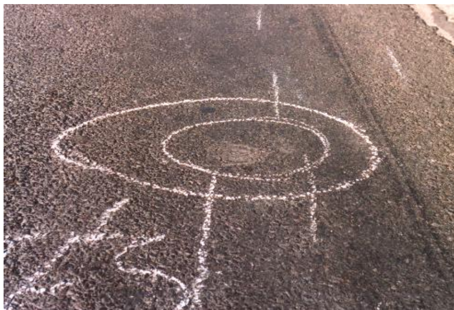
5.5. ábra: Gyalogos lábbelijének az elütés következtében keletkezett nyoma (Saját készítés)
