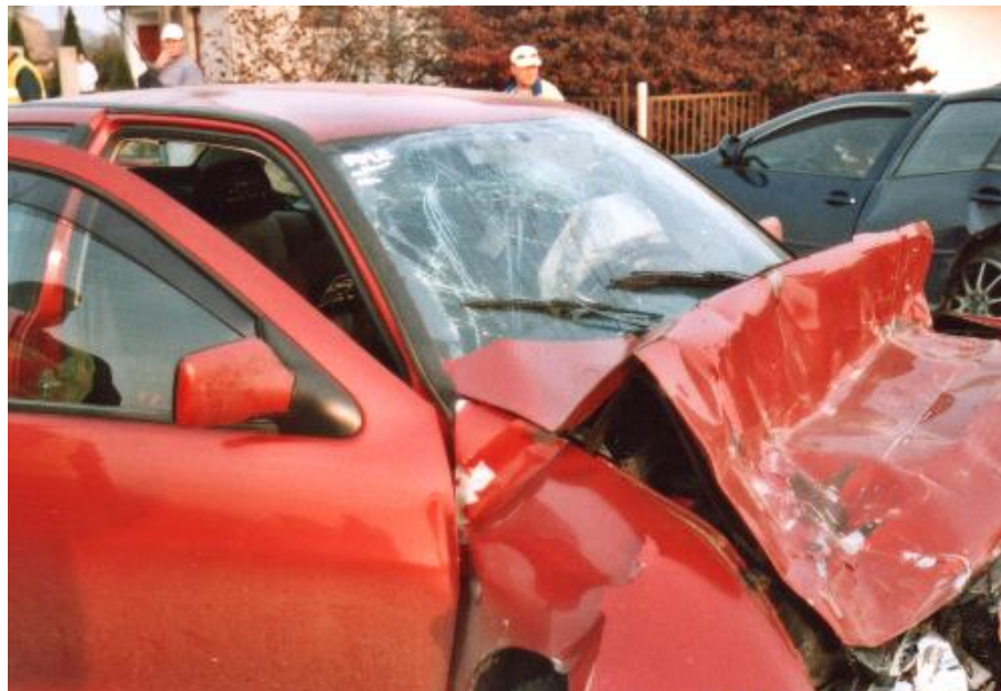
5.2. ábra: Fényképfelvétel személygépkocsi „kifejelt” szélvédőjéről (Saját készítés)
