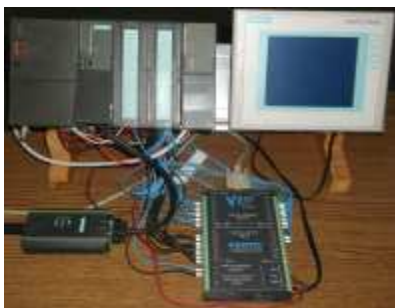
8. ábra: Festo Veep és EasyPort modulok
