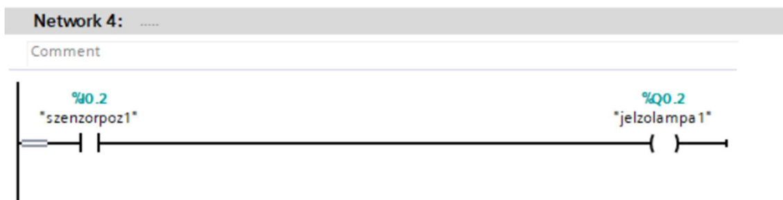
34. ábra: A szenzorok és jelzőlámpák logikai kapcsolata - saját ábra
