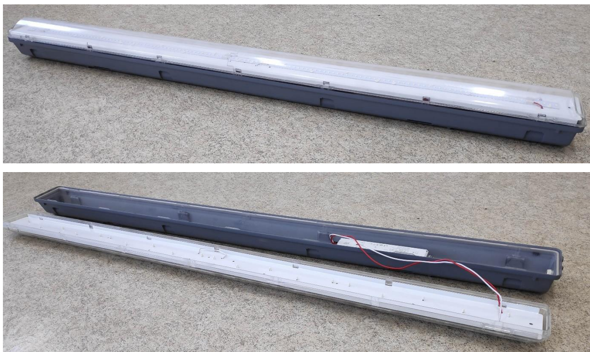
4.1. ábra. 3D nyomtatással készült preparált világítótest
