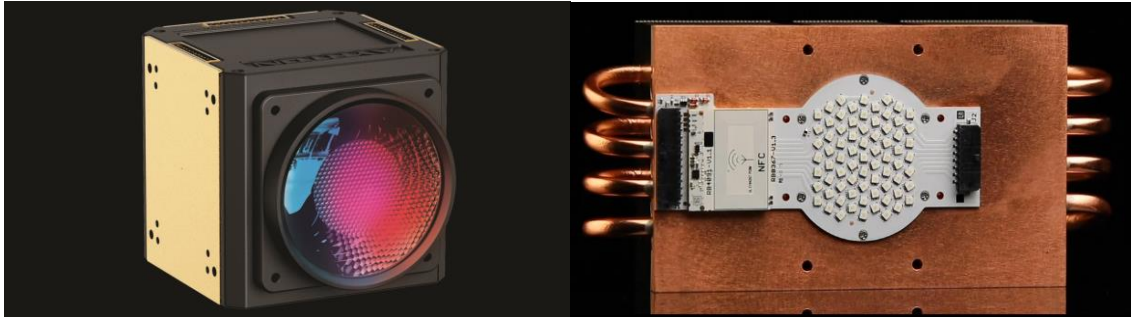
1.5 ábra. Intelligens robotlámpák LED moduljai [3]
