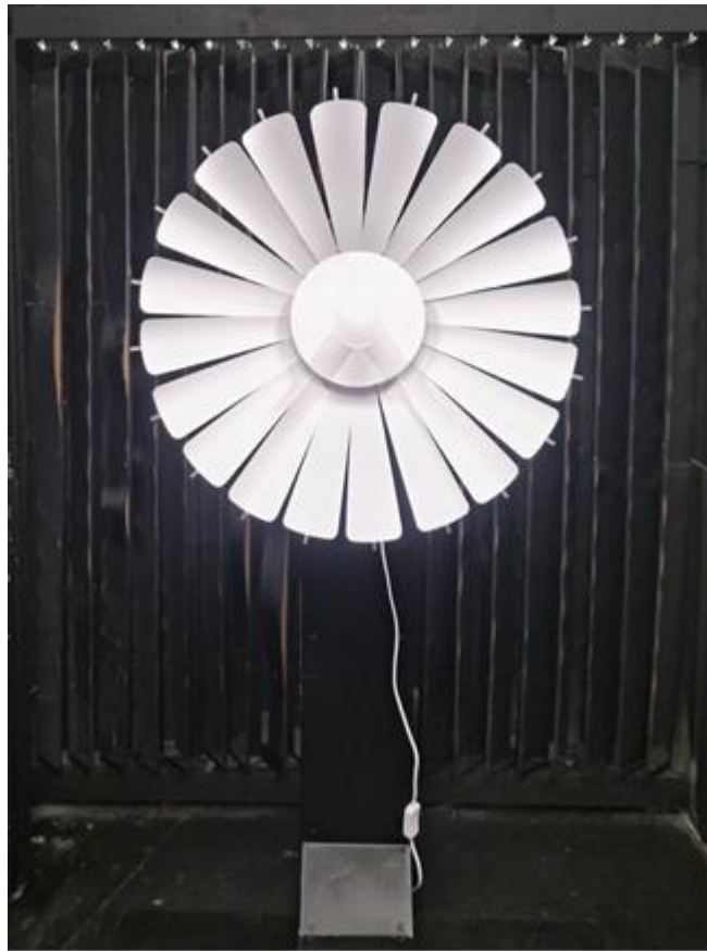
4-3. ábra 110°-os nyílásszögű beállítás a goniofotométeren
