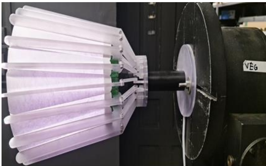
4-4. ábra 25°-os nyílásszögű beállítás a goniofotométeren
