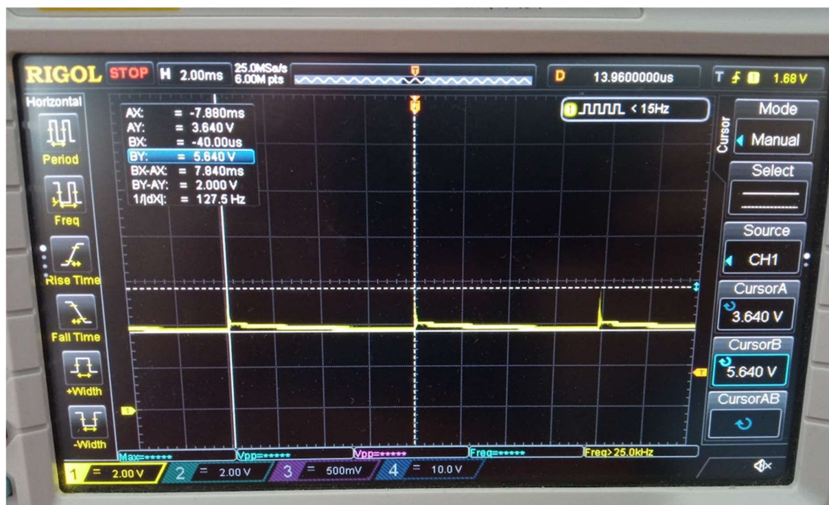
17.: A tesztelő modul kimenő feszültsége az első bekapcsolás során
