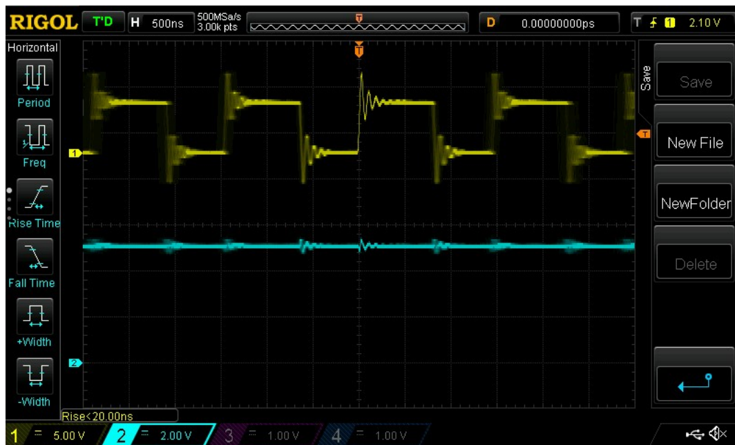
29. ábra: MT3608 3,5V bemenet 196Ω terhelés esetén
