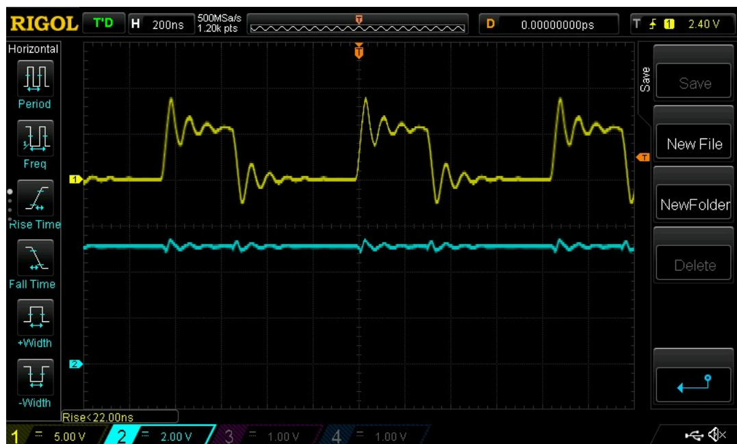
28. ábra: MT3608 2V bemenet 196 \Omega terhelés esetén
