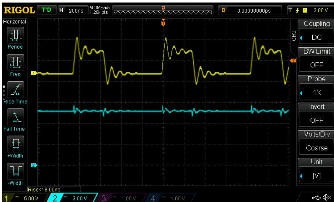
33. ábra: MT3608 2V bemeneti feszültség és 34\Omega terhelés esetén áramkorlát nélkül
