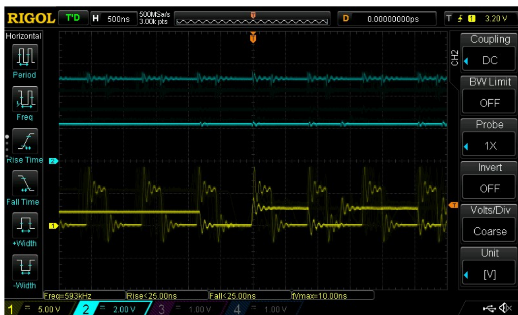
31. ábra: MT3608 2V bemeneti feszültség és 34\Omega terhelés esetén
