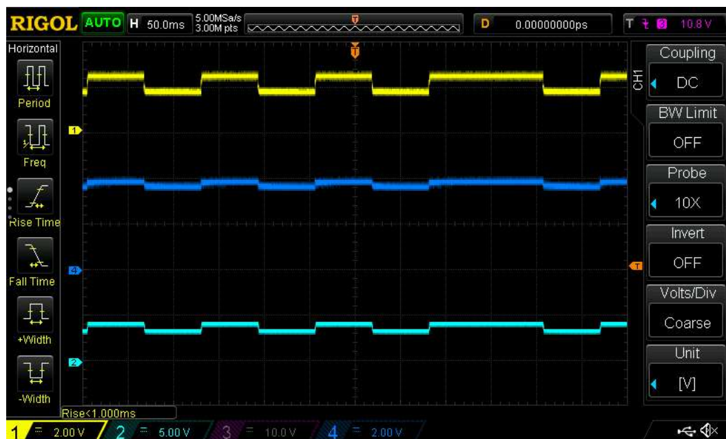
58. ábra: 1F szuperkondenzátor mellet vizsgálat 5mA terhelés mellett
