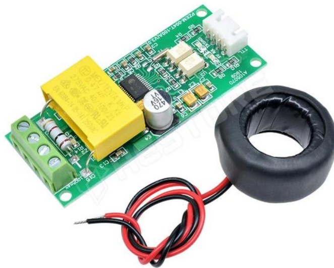
5. ábra – Peacefair PZEM-004T - Multifunkciós feszültség, áram, teljesítmény mérő modul
