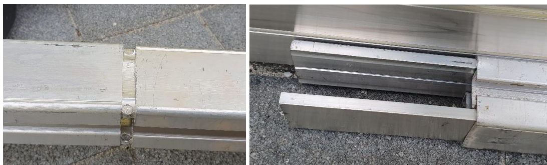
3.15 ábra: 40x40 mm-es szerelősín sántoldó / Forrás: szerző saját fotói.
