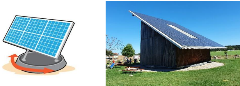
3.36 ábra: Egytengelyű napkövető elve, Épület Németország, Oberreith / Forrás: sinovoltaics.com , Szerző saját fotói
