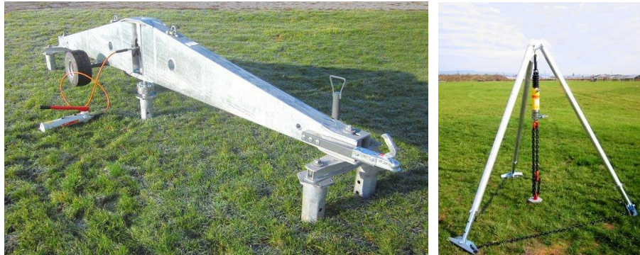
3.42 ábra: Talajcsavar terhelőhid és állvány / Forrás: www.krinner.io
