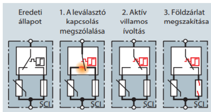
Ábra: DC ív megszakítása túlfeszültség-védelmi eszközön belül [15]
