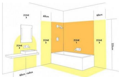
2. ábra: vizes helyiségek védelmi zónái
