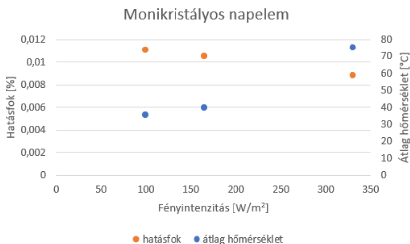
33. ábra Monokristályos napelem hatásfok és átlaghőmérséklet értékek a fényintenzitás függvényében
