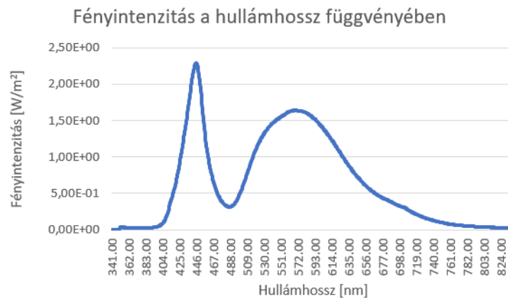
23. ábra Fényintenzitás a hullámhossz függvényében (LED-es napszimulátor esetén)
