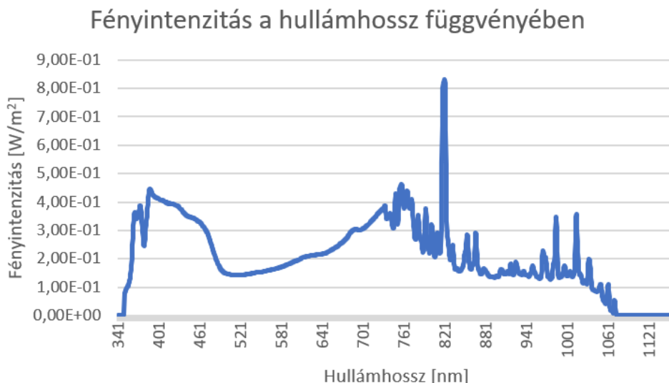
20. ábra Fényintenzitás a hullámhossz függvényében (állónapszimulátor esetén)
