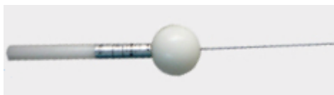
20. ábra IP4X vizsgáló eszköz
