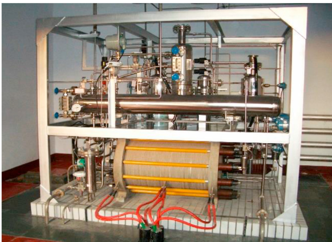
9.2. ábra. 800 \text{ Nm}^3/\text{h} lúgos elektrolizátor, amelyet a Kínai Állami Hajóépítő Társaság 718. Kutatóintézete (CSSC) fejlesztett ki. [41]
