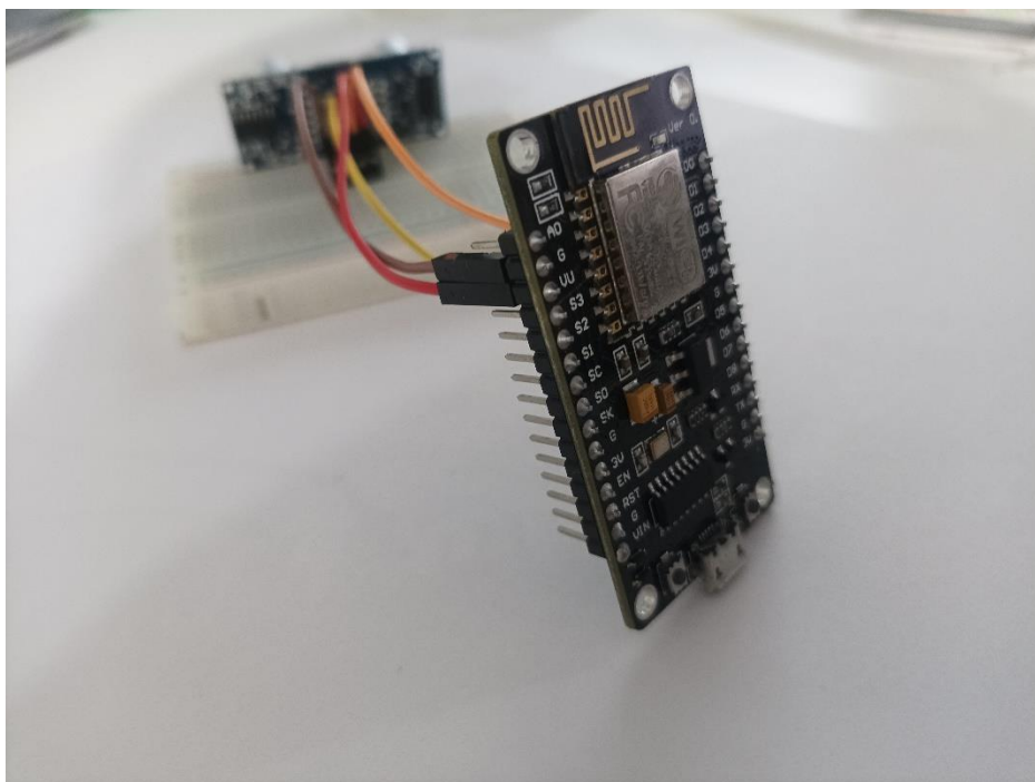
12.18. ábra: A szenzort 5 V feszültséghez és a GND-hez van csatlakoztatva
