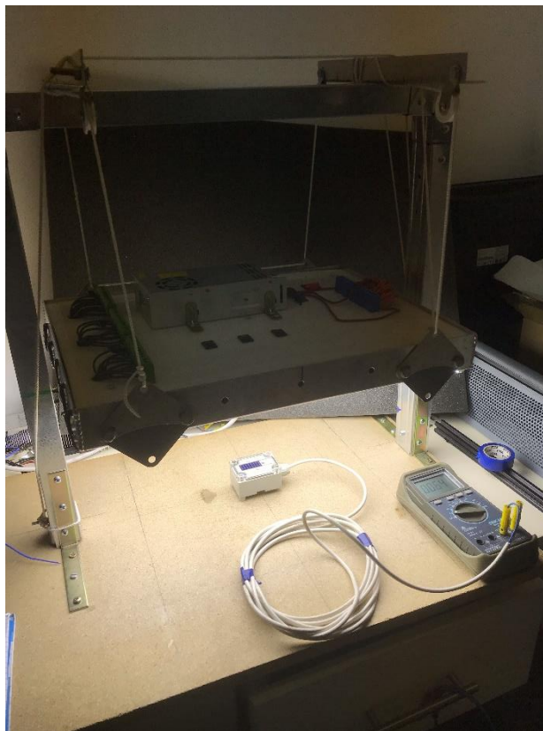
14. ábra A fényintenzitásmérőn eső feszültség mérése digitális multiméterrel [saját kép]
