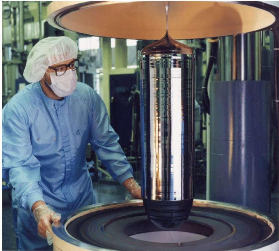
4. ábra Czochralski-módszerrel előállított szilíciumhenger [27]
