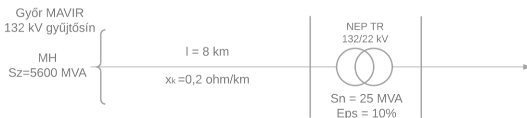
45. Ábra Zárlatszámítási séma
