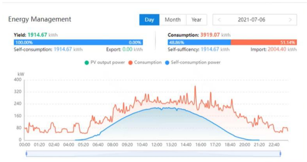
5.2.1. ábra Visszwatt szabályozással ellátott napelemes erőmű
