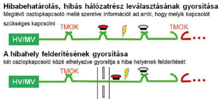
5.5. ábra TMOK közökbe történő telepítés [21]
