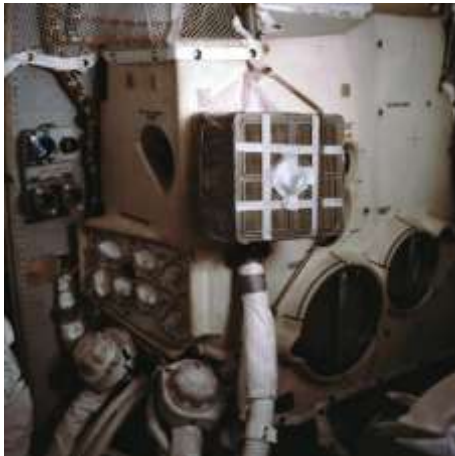
4.1. ábra: Apolló 13 – Szén -dioxid -eltávolító kiegészítő rendszer
