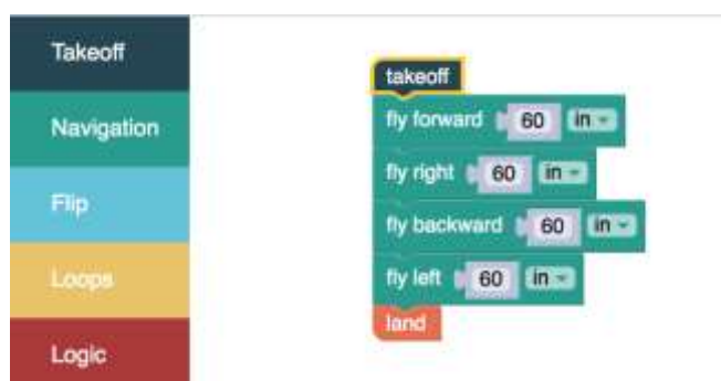
4.28. ábra: DroneBlocks applikáció – útvonal berepülése a drón órának előre tartásával
