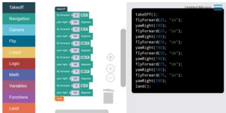
4.35. ábra: DroneBlocks applikáció – Drón előre- és visszaküldése változók nélkül programkód
