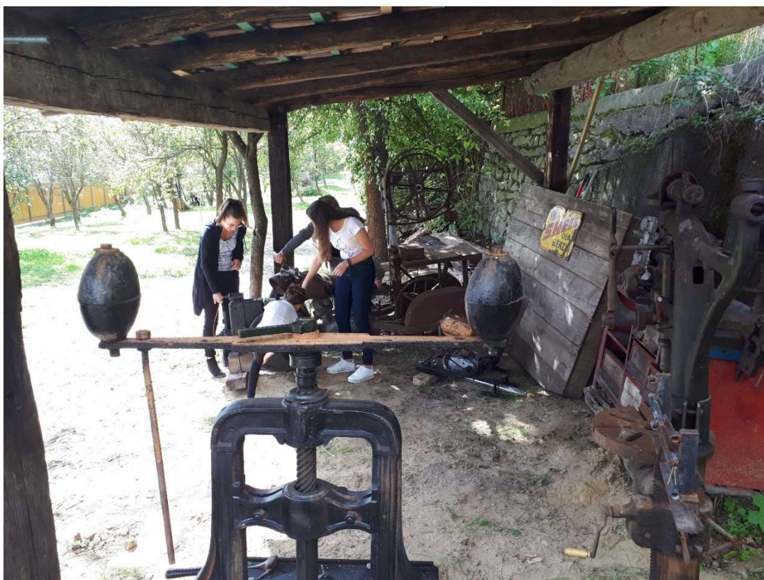
14. Pénzverdei golyósprés balról, jobbról egy transzmissziós hajtású fúró-, hólógép az 1800-as évek végéről
