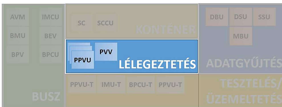
14. ábra MassVentil – A Páciens-lélegeztetési alrendszer és komponensei
