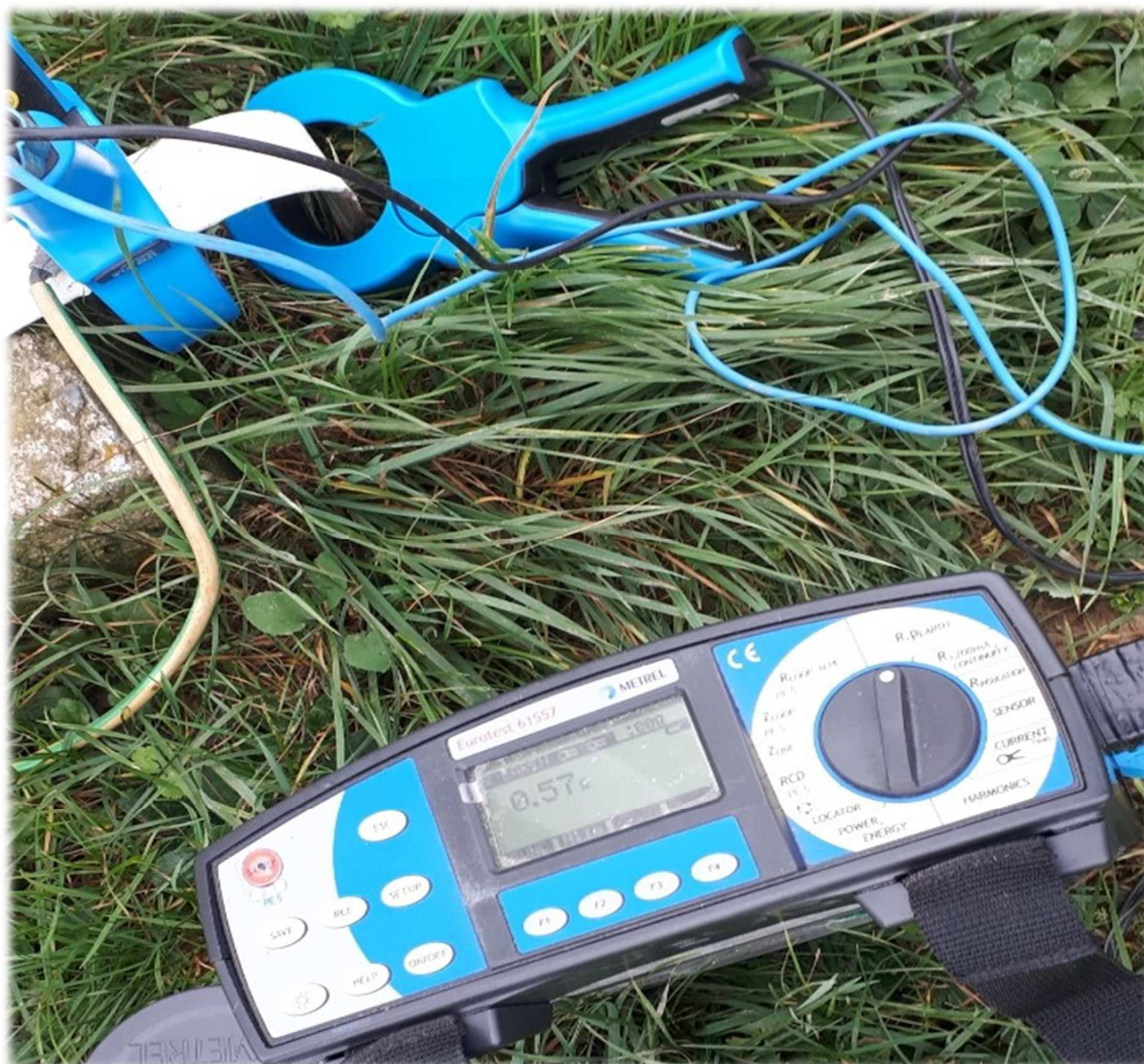
39. ábra „A” állomás földelési ellenállása 42
