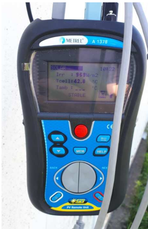
88. ábra Mertel adatgyűjtő mérési eredményei 106
