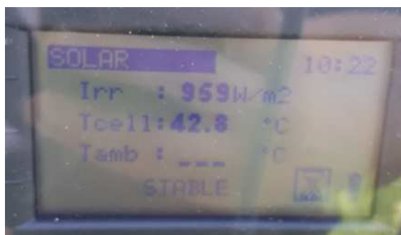
70. ábra Az adatgyűjtő műszer fény és hő mérés kijelzése 73
