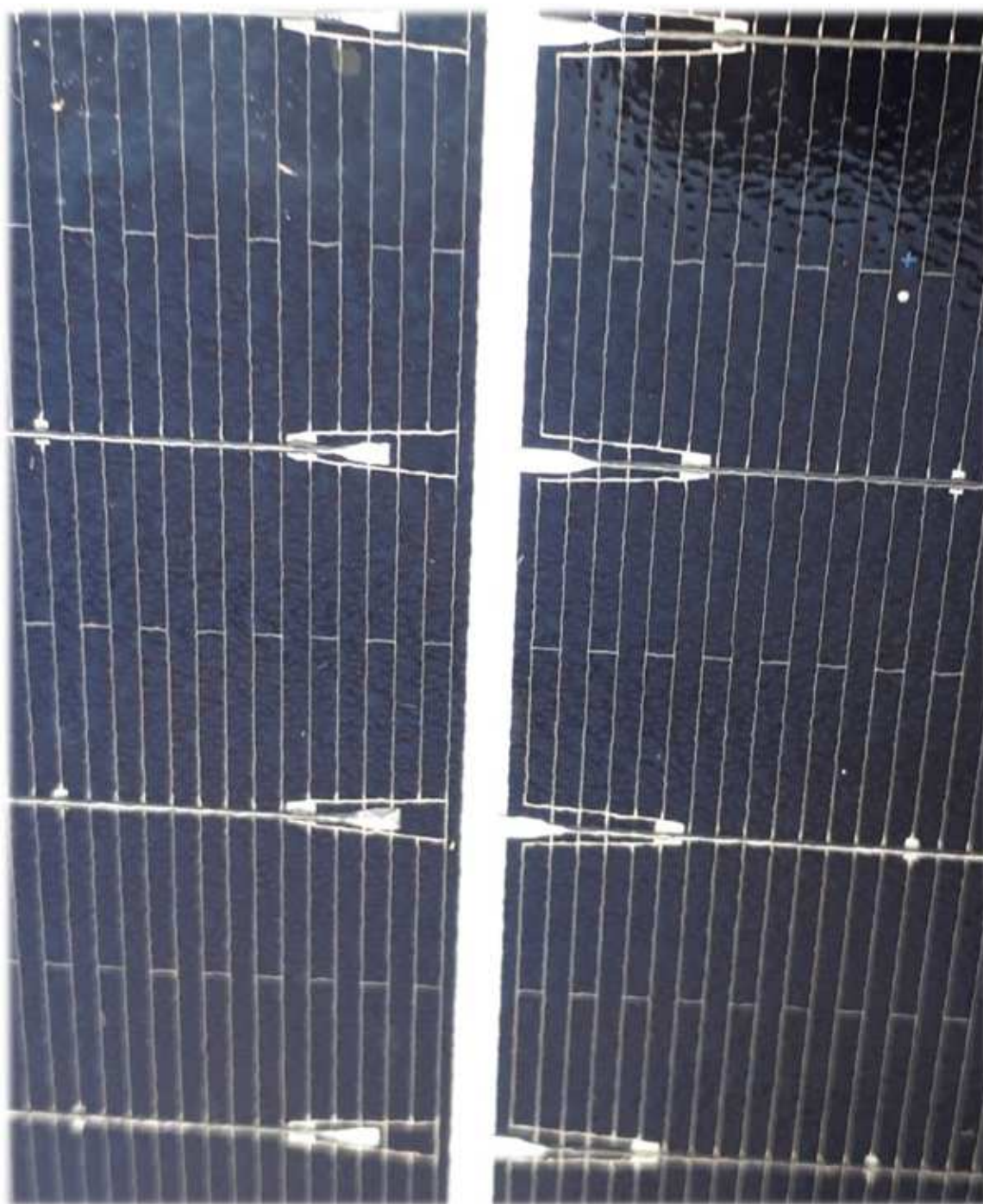
45. ábra Részletesebb fotó, melyen jól látható az üvegréteg homogén, érdes felülete 48
