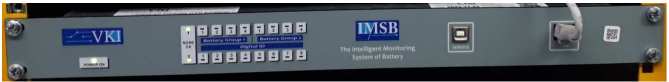
9. ábra Intelligens Akkumulátor Felügyeleti Rendszer – IMSB 9
