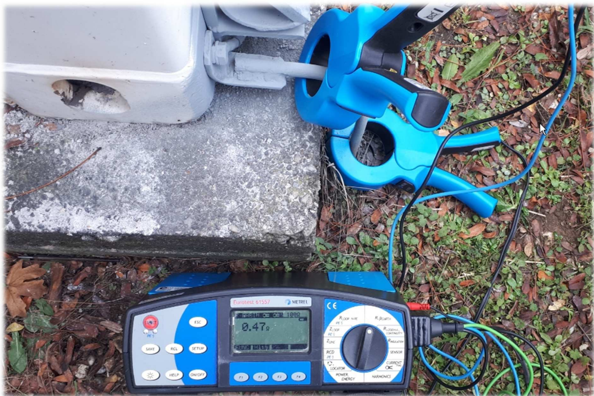
38. ábra „B” állomás földelési ellenállása 41
