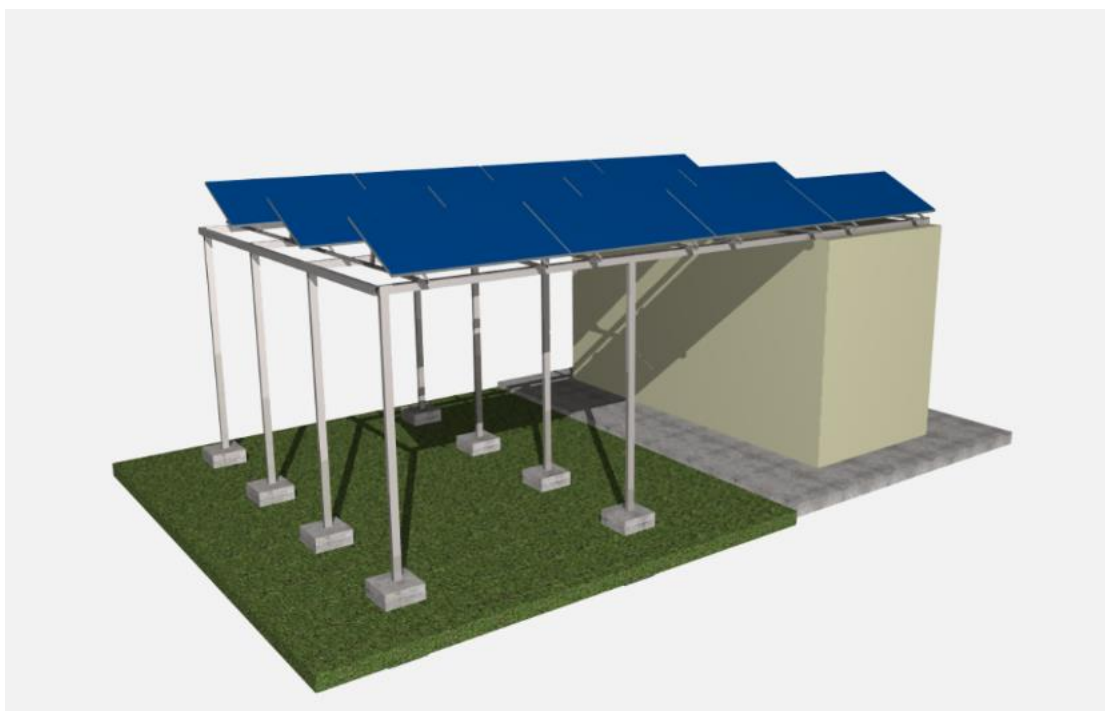
22. ábra. Konténerre és talajra, vegyes telepítésű tartószerkezet nézeti rajza. 21
