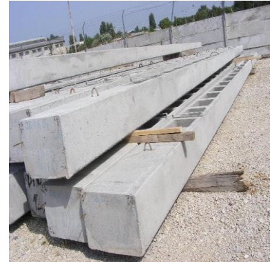
13. ábra-B10/800 áttörtgerincű beton oszlop
