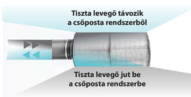
6.5 ábra: Kétirányú védelem – küldés és fogadás (szívás és fújás) közben is
