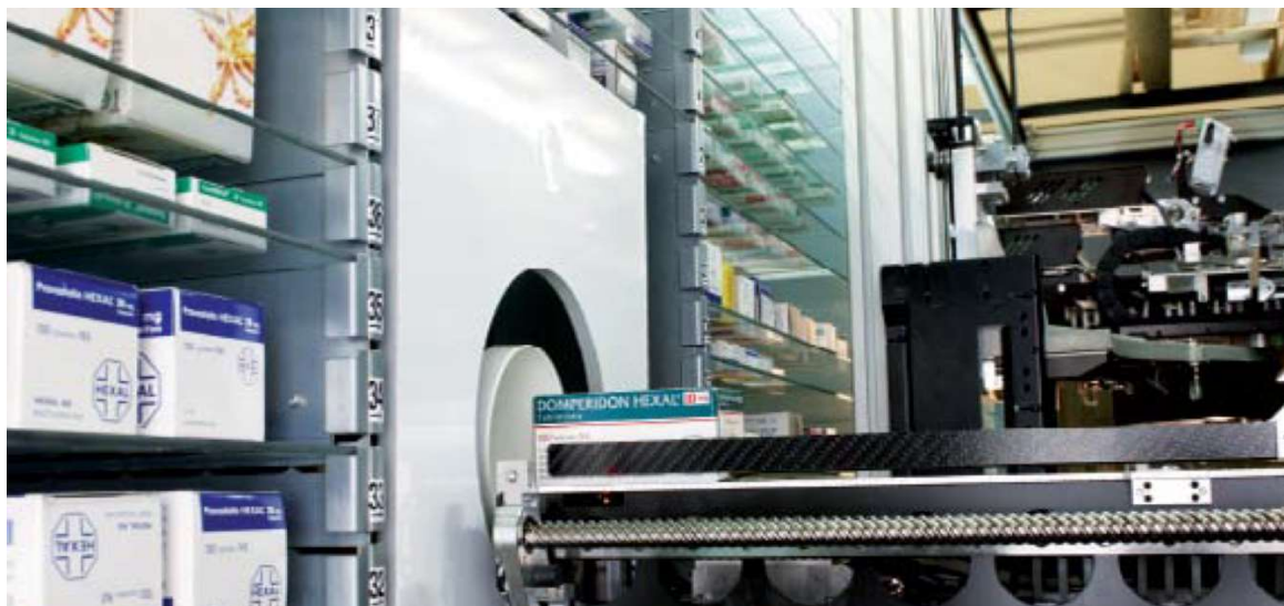
2.8 ábra: Automata küldő állomás a gyógyszerértári automata rendszer részeként
