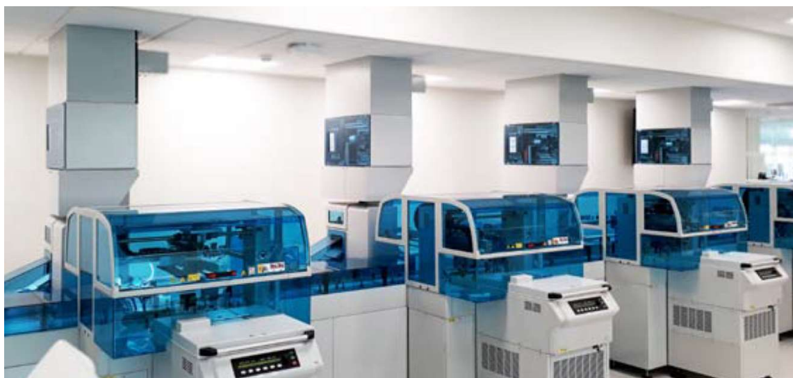
2.7 ábra: Automata fogadó állomás integrálása a minta-előkészítő és szortírozó preanalitikai rendszerhez
