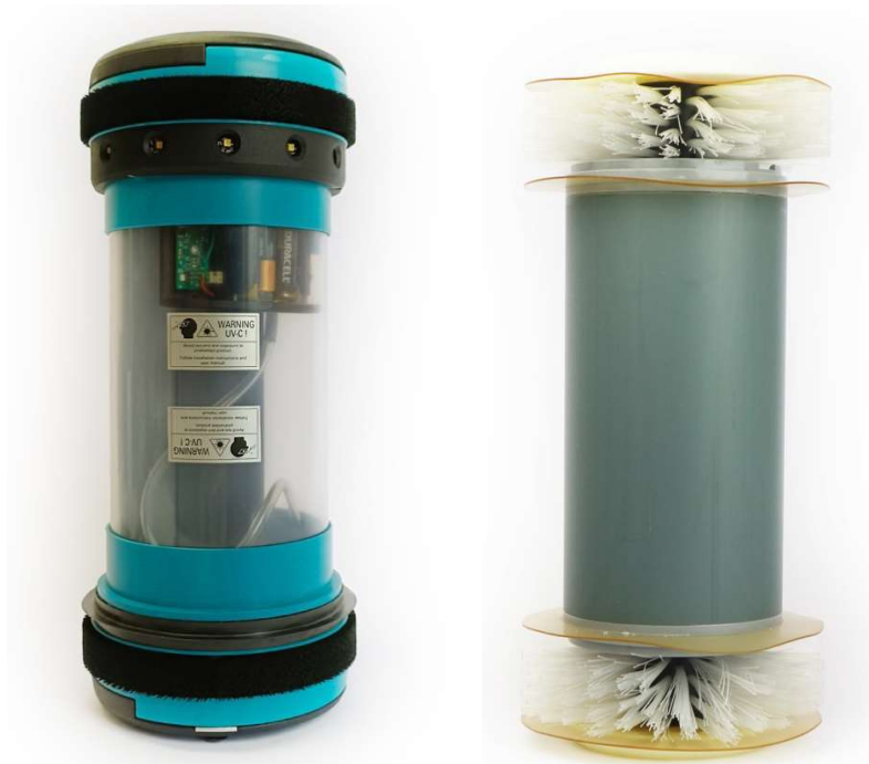
6.11 ábra: Fertőtlenítő kapszula és mechanikus tisztító kapszula különbsége
