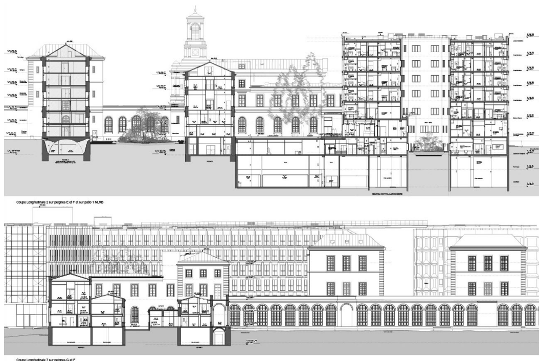
40. ábra: a kórházépület bővítésének metszetrajzai 20 [17]
