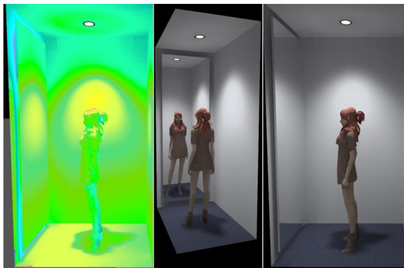
3.6. ábra. Középen elhelyezett, lefelé sugárzó próbafülke-világítás [7]
