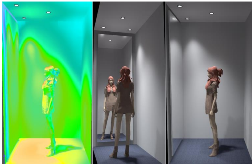
3.7. ábra. Háromszög alakzatban elhelyezett, lefelé sugárzó próbafülke-világítás [7]
