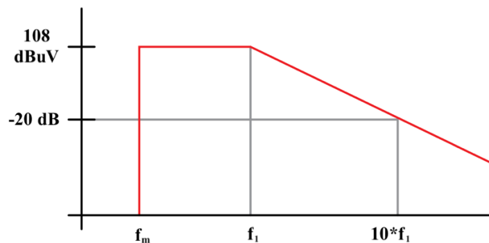
3.2.4.ábra: Állítható kitöltési tényező esetén a differenciál-módusú zaj.
