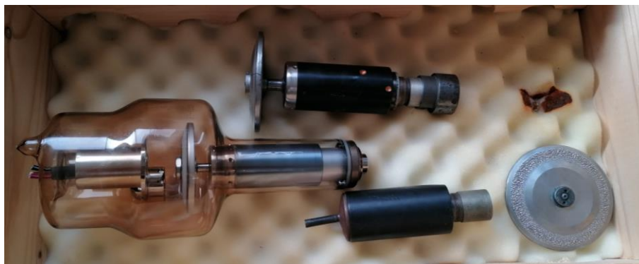
10. ábra: Röntgencső és részei forrás: Saját készítésű felvétel (készült: Controll-X Medical Kft.-nél)
