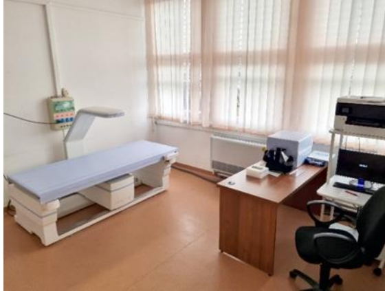
12. ábra: Üzemkész Horizon Wi típusú csontsűrűségmérő röntgenberendezés
