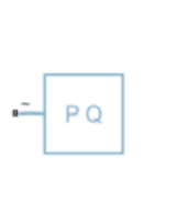
3.2.2.9. ábra: Állandó teljesítményterhelő blokk [31.]
