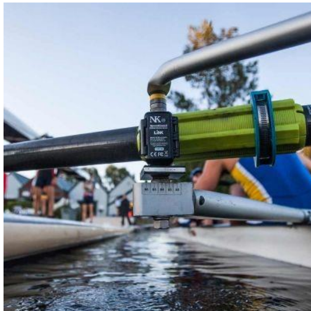
5. ábra: EmPower Oarlock szenzor [5]
