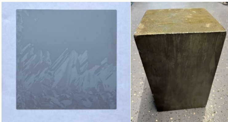
1. ábra Polikristályos szilícium wafer és szilícium blokk (saját készítésű kép)
