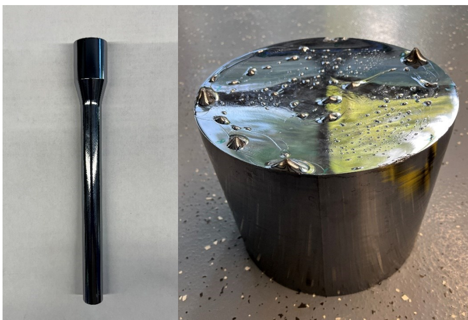
4. ábra Monokristályos szilícium seed és ingot (saját készítésű kép)
