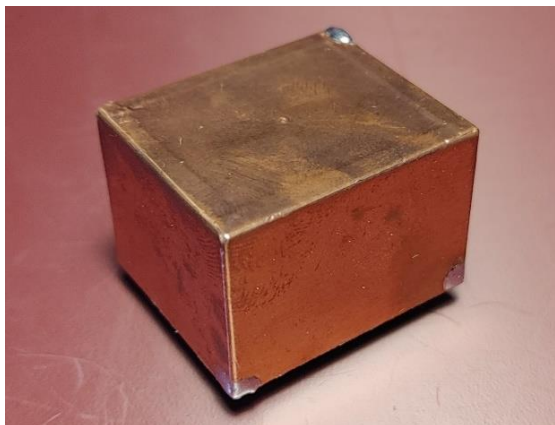
15.4/2. kép: Árnyékoló rézfólia felragasztva [saját ábra]
