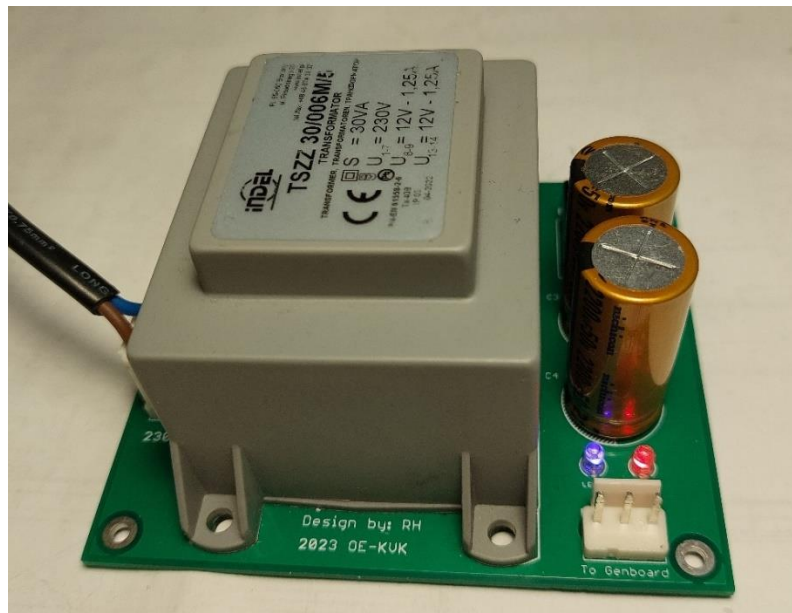
35. ábra: A megvalósított főtápegység [Saját kép]
