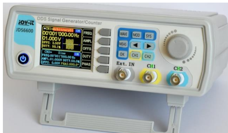
7. ábra: A JOY-iT JDS6600 DDS függvénygenerátora [17]
