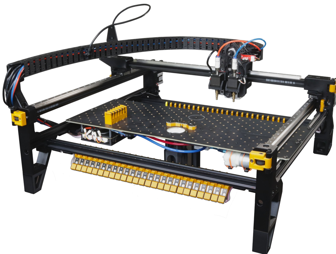
1. Ábra: Opulo asztali beültető gép
