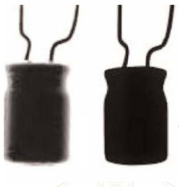
7. ábra Kondenzátor képe normál háttérmegvilágítás és kollimátor használatával [3]
