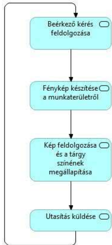
2. Ábra Központi egység működésének blokkdiagramja.
