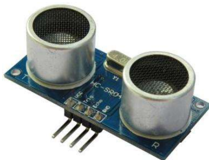
16. Ábra HC-SR04 [Forrás: https://www.electroschematics.com/hc-sr04-datasheet/ ]
