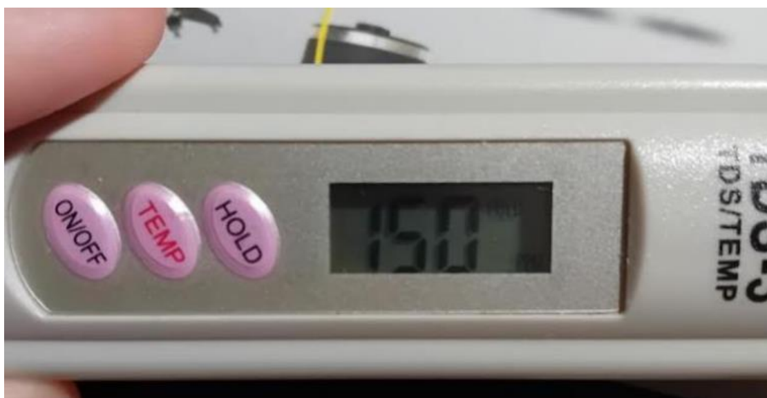
24. ábra: TDS-3 mérőműszer által kapott érték: 150ppm
