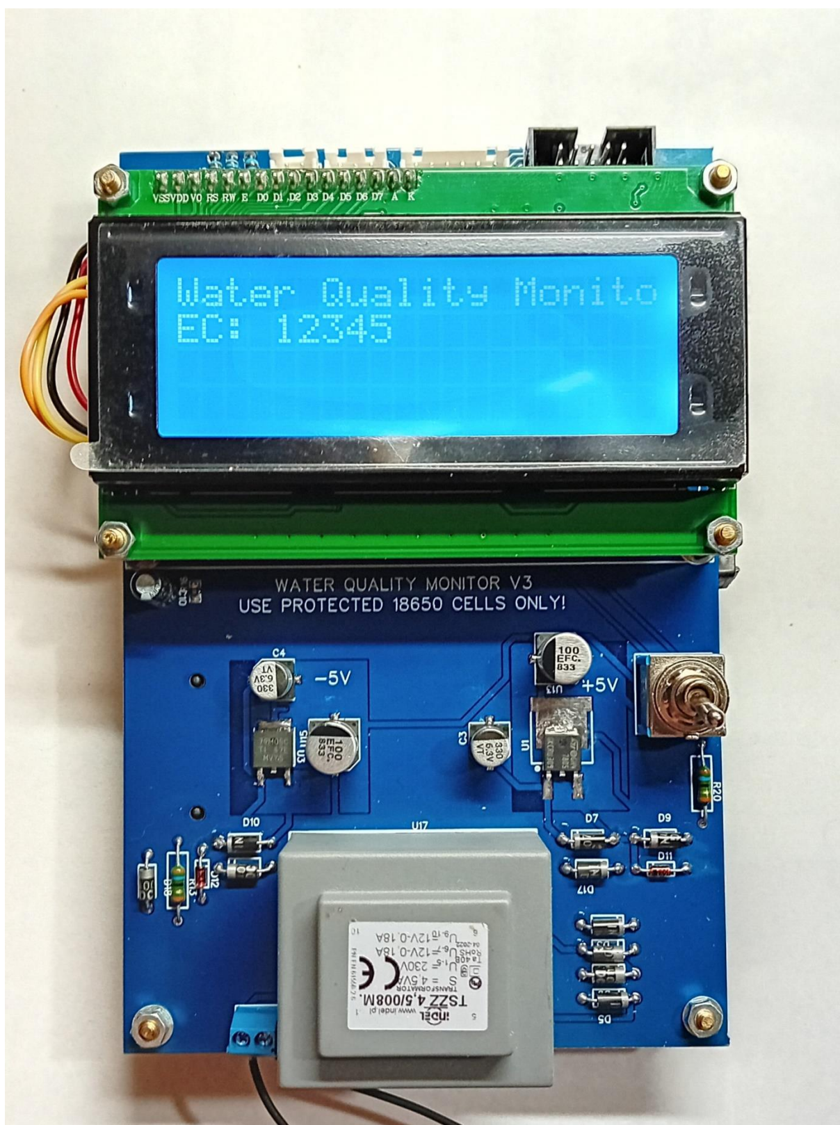
30. ábra: A forrasztást követően a NYÁK programtesztelés alatt
