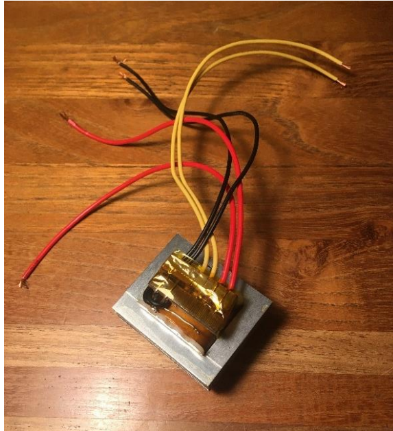
3.7. ábra: Újratekercselt transzformátorom [saját kép]
