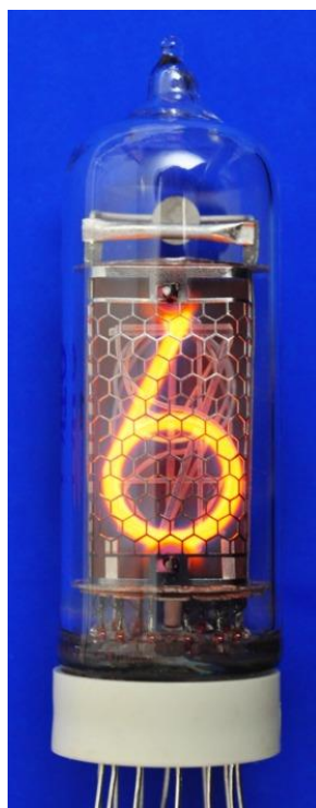
3.1. ábra: Gazotron IN-14 (Газотрон ИИ-14) nixie-cső
