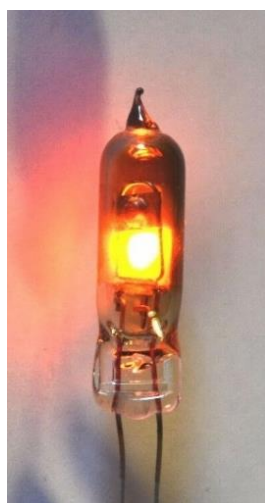
3.2. ábra: Gazotron IN-3 (Газотрон ИИ-3) neon jelzőlámpa
