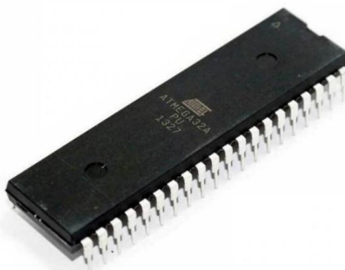
3.5. ábra: Microchip ATmega32A (PDIP) mikrovezérlő
