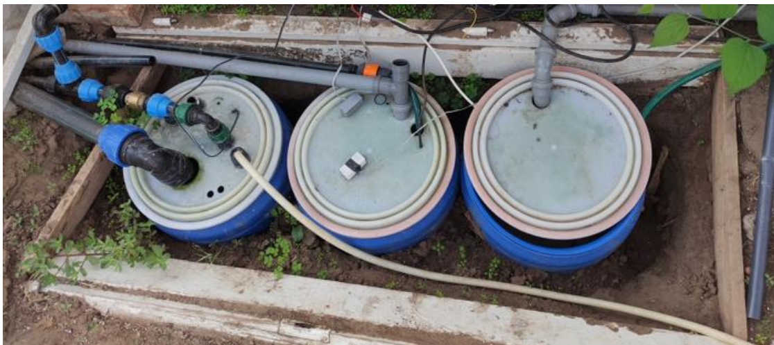
61. ábra – Tartályok a három különböző rendszerhez. A szürke és fehér kis dobozok az ultrahangos szenzorok [saját ábra]
