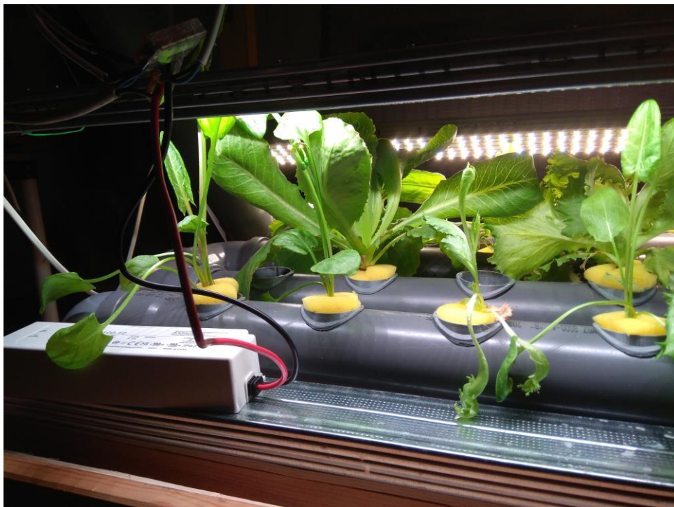
51. ábra – Saláta, sóska. Tápegység: MeanWell (LPV-150-12), IP67-es, vízbe merítés ellen védett [saját ábra]
