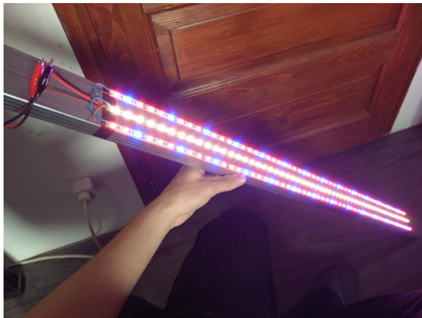
49. ábra – Gipszkartonprofilra ragasztott LED szalagok [saját ábra]
