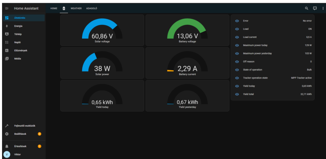
60. ábra – Töltésvezérlőből megjelenített adatok [saját ábra]
