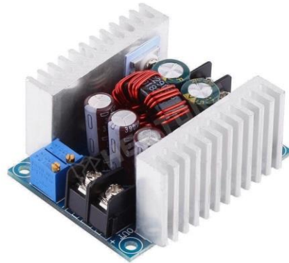
41. ábra – Kapcsolóüzemű step-down tápegység, SPX-20A [23]
