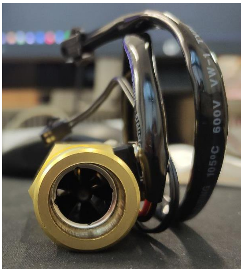
35. ábra – Látszódik belül az impeller [saját ábra]
