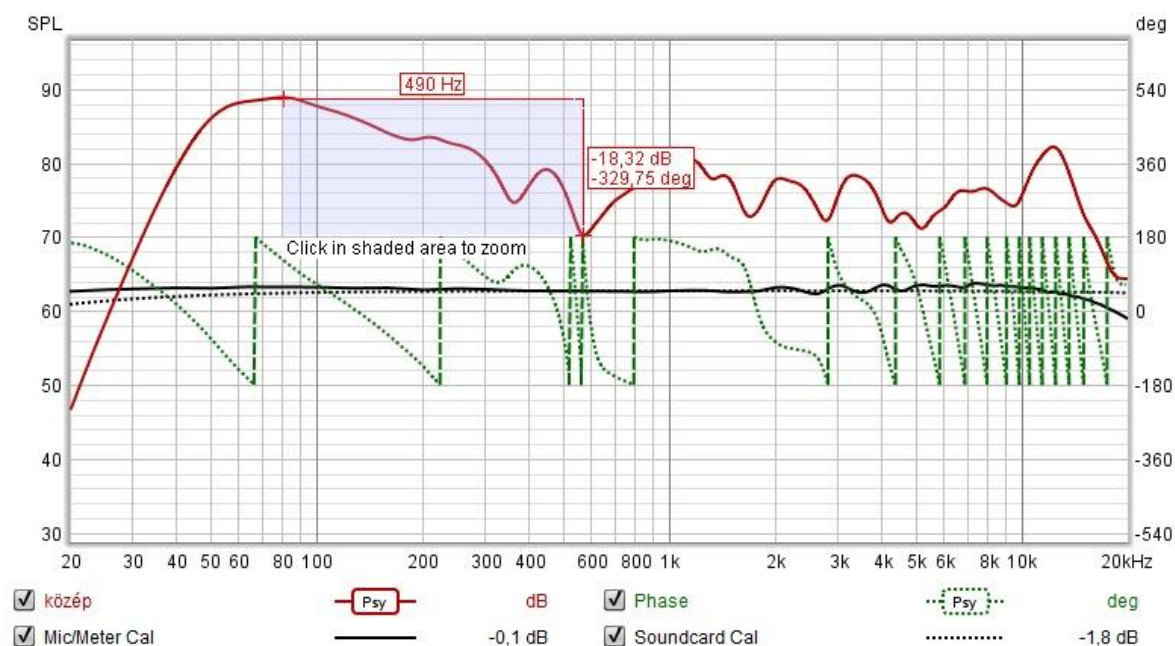
3.3.2 1. ábra: Mérés során tapasztalt hangnyomásingadozás frekvencia függvényében
