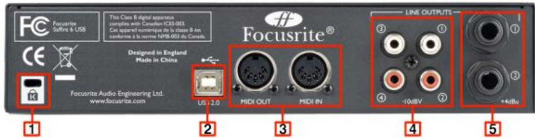
3.1.3. 2. ábra: A hangkártya hátlapja, és kimenetei: [8]
