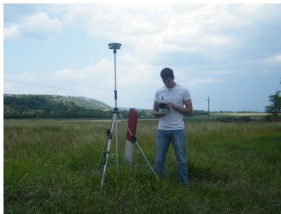
4.4 ábra hálózatos RTK mérés a 64-4312-es IV. rendű EOVA alappontján
