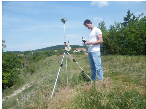
3.5 ábra Mérés a mikrohálózati ponton, igazított libellával
