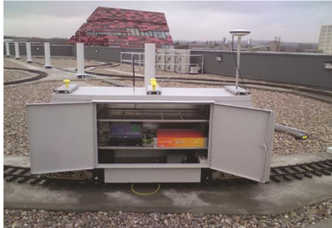
4-6. ábra Tesztmozdony a Nottingham Geospatial Institute tetején kialakított tesztpályán (University of Nottingham) [12]
