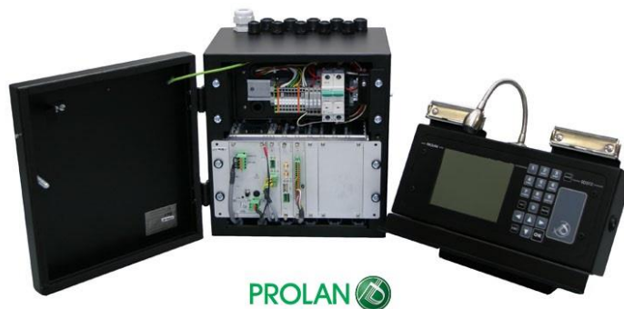
4-4. ábra Mozdonyfedélzeti Berendezés (MFB) (forrás: www.prolan.hu )
