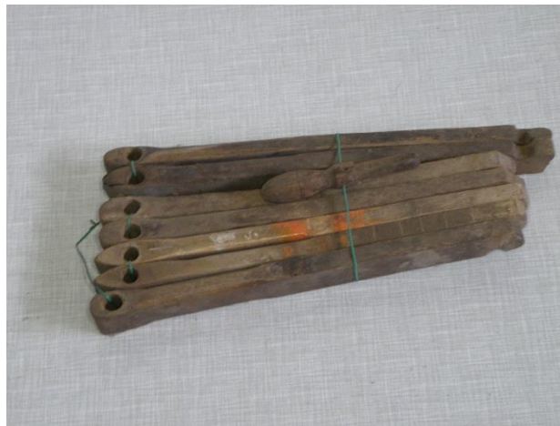
3. kép: keretes fűrészek szétzerelve (forrás: saját gyűjtemény)
