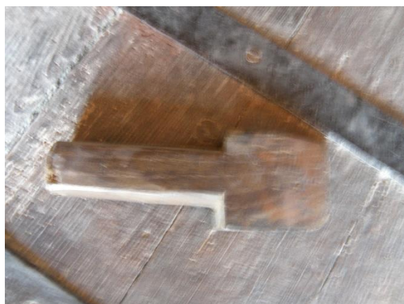
14. kép: szigetelés döngölő (forrás: Ráckevei Hajómalom múzeum)
