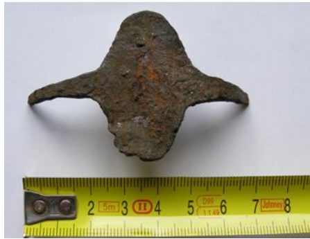
15. kép: iszkába szög vasból, forrás: https://bencsik.rs3.hu/a-sarki-jeg-a-2020-as-evekben/234-hajok-toertenete-a-kelet-mediterraneum-a-minosziak-a-huekszoszok-es-a-tengeri-nepek-hajoepitese-az-i-e-1100-as-evekig.html
