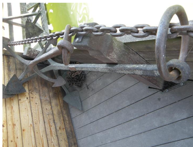
22. kép: horgonyok láncsal és közepén a rögzítés céljára faragott gerenda (forrás: Ráckevei Hajómalom Múzeum)
