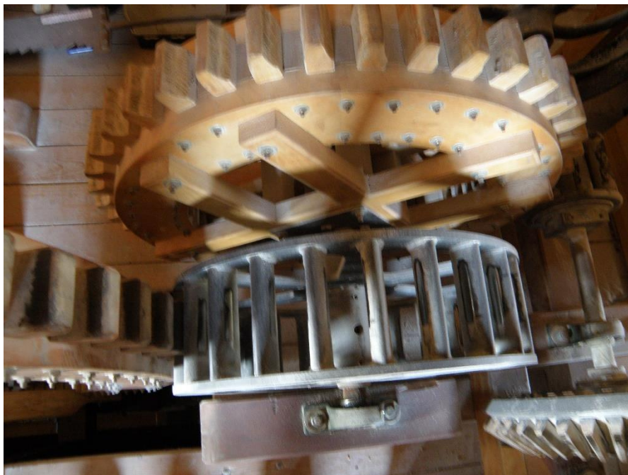
18. kép: fa fogaskerekek kiegészítve modernebb fém kerékkel (forrás: Ráckevei Hajómalom Múzeum)
