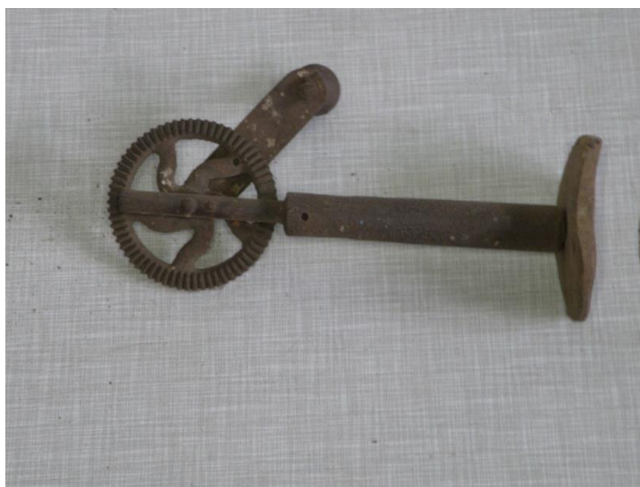
11. kép: furdancs fúrószár nélkül (forrás: saját gyűjtemény)
