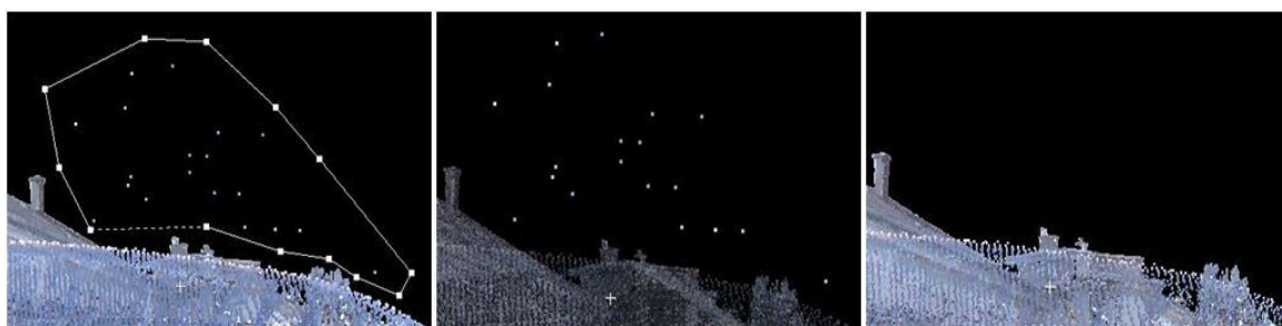
5.10. ábra: A kivágás menete, balról-jobbra: körberajzolás poligonnal, szegmentálás, törlés utáni állapot
