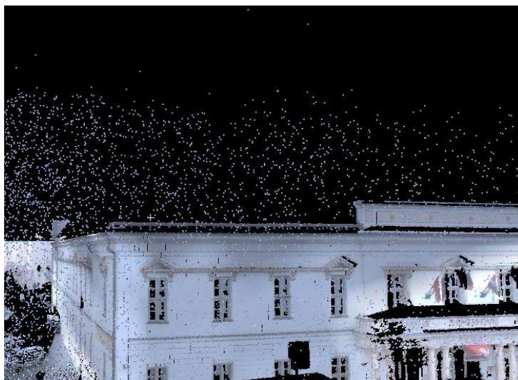
5.9. ábra: A második álláspontból készített pontfelhő az első, sík elhelyezkedése szerinti szegmentálással kijelölt pontok törlése után
