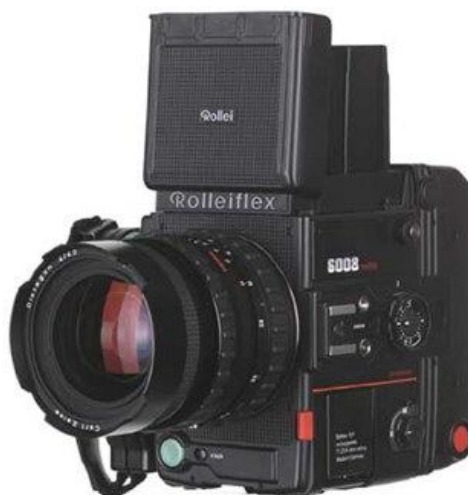
4.2. ábra: A Rolleimetric Rolleiflex 6008 nagy felbontású, tükörreflexes, digitális mérőkamera (forrás: http://www.geo.info.hu/portal2007/images/stories/hirek/2010/20100115_3.jpg )
